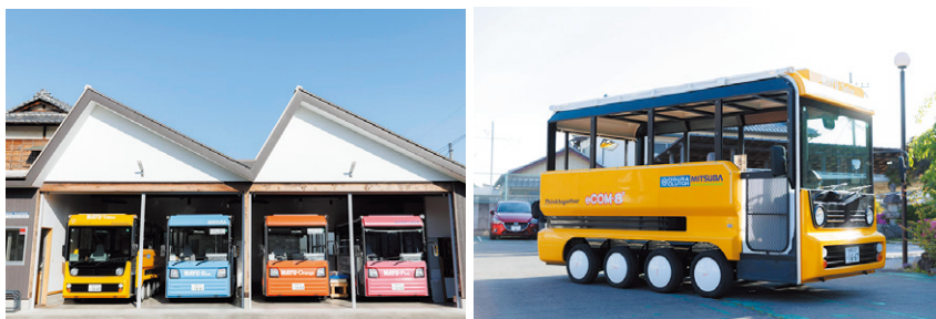
図1 鮮やかな色の車体が目を引く「MAYU」。計5台ある車体管理は桐生再生社が担っている。eCOM-8の改良型であるeCOM-8 2 (右)は、営業車両の登録ができるように車内の寸法を調整したほか、将来的に自動運転することも想定し、必要なカメラを取り付けるためのスペースも用意している。
