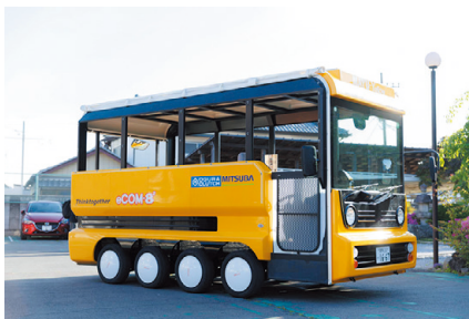
図1 鮮やかな色の車体が目を引く「MAYU」。計5台ある車体管理は桐生再生社が担っている。eCOM-8の改良型であるeCOM-8 2 (右)は、営業車両の登録ができるように車内の寸法を調整したほか、将来的に自動運転することも想定し、必要なカメラを取り付けるためのスペースも用意している。
