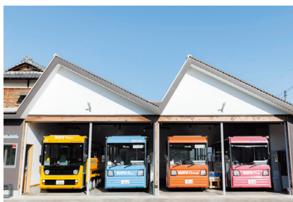
図1 鮮やかな色の車体が目を引く「MAYU」。計5台ある車体管理は桐生再生社が担っている。eCOM-8の改良型であるeCOM-8 2 (右)は、営業車両の登録ができるように車内の寸法を調整したほか、将来的に自動運転することも想定し、必要なカメラを取り付けるためのスペースも用意している。
