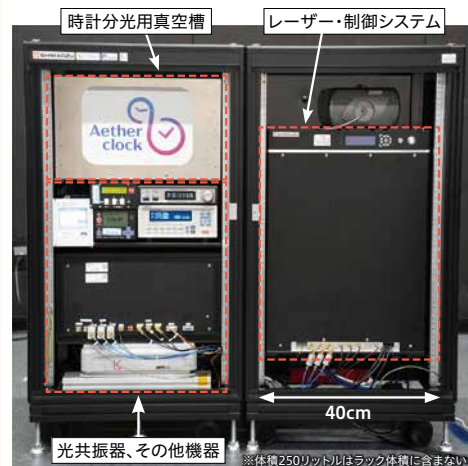
開発した超高精度小型光格子時計装置。冷却した原子を光格子中に捕獲し、黒体放射シールドの中で時計遷移を高精度に分光する。この分光を行う時計分光用真空槽、それに必要な光共振器やレーザー・制御システムを搭載している。横の大きさは40センチメートルと非常に小型だ。
