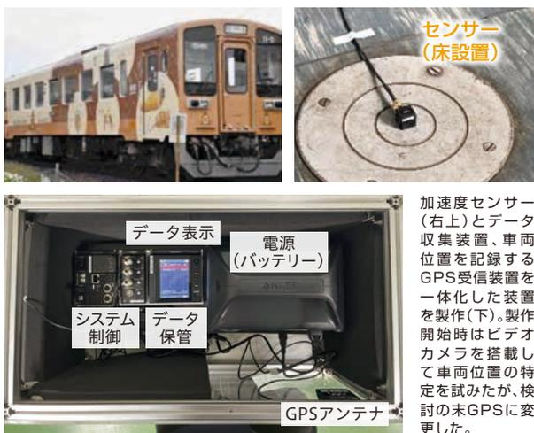
加速度センサー(右上)とデータ収集装置、車両位置を記録するGPS受信装置を一体化した装置を製作(下)。製作開始時はビデオカメラを搭載して車両位置の特定を試みたが、検討の末GPSに変更した。
