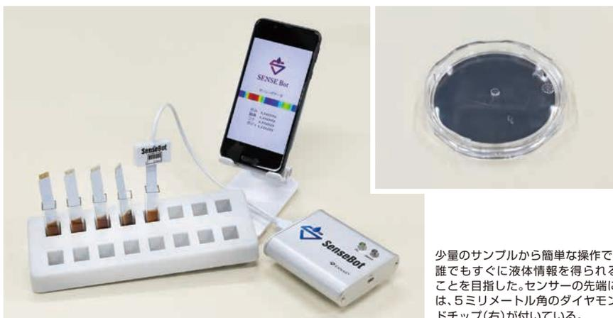
少量のサンプルから簡単な操作で、誰でもすぐに液体情報を得られることを目指した。センサーの先端には、5ミリメートル角のダイヤモンドチップ(右)が付いている。
