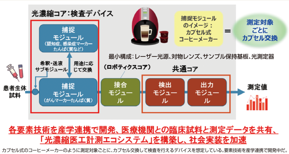
図5 LAC-SYSのマルチ検査デバイスのコンセプト
