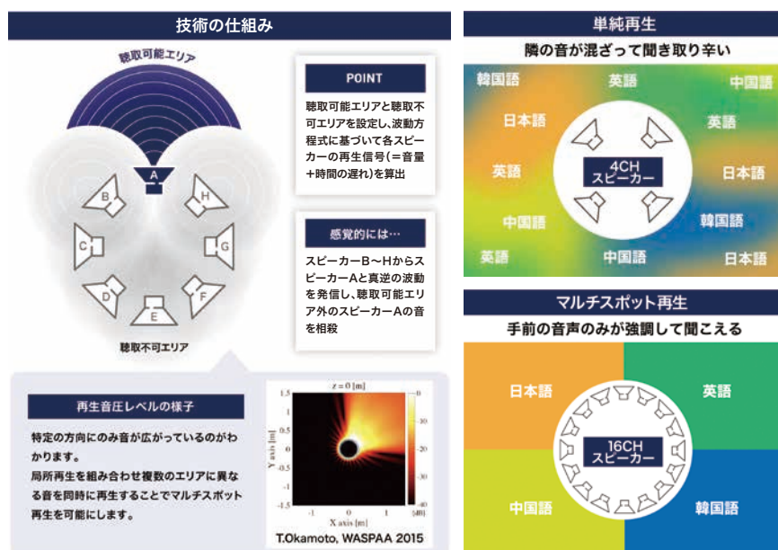
図1 音声マルチスポット再生技術の仕組み
