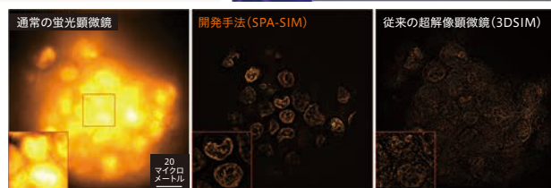
開発されたSPA-SIMと従来の超解像顕微法を比較した画像。生きた細胞の3D蛍光像(上)、細胞スフェロイドの蛍光像(下)ともに解像度が上がり、生体内部の観察が可能となった。
