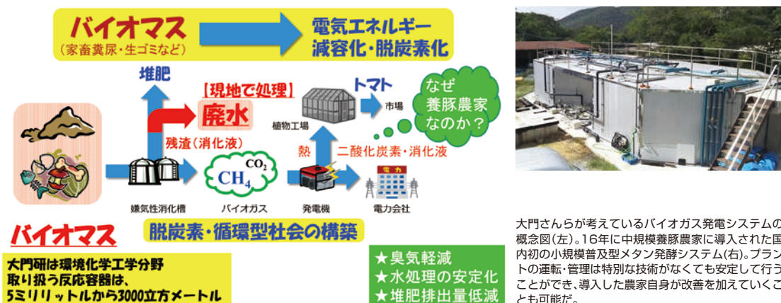
図2 バイogas発電システムの概念図と導入事例
