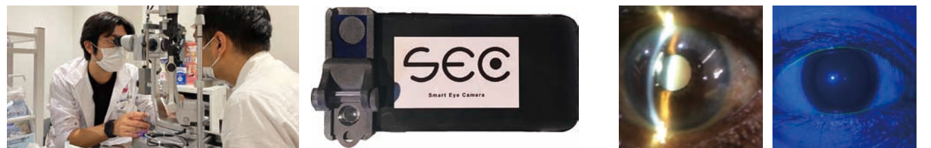
一般に眼科で使用される細隙灯顕微鏡(左)。SECはスマホのカメラレンズに装着するだけで前眼部の観察ができる(右)。
