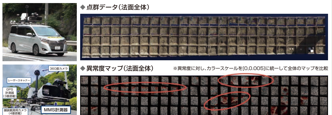
【図3】 レーザースキャナーとAI技術を活用した道路法面の異常検知
