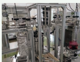
創発で開発している、アイスコア中の空気を抽出する装置です。真空中で氷を砕き、閉じ込められている空気を抽出します。
