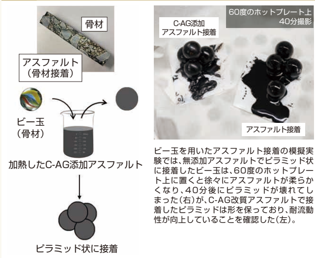
図2 C-AG添加アスファルトの接着性実験
