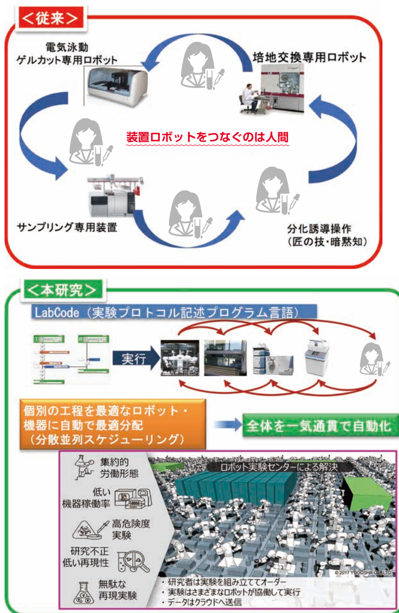
機器間の仲介作業を研究者が担う従来プロセス(上)から、個々の工程をロボット、機器に自動で配分する「プログラミング」によって実験全体プロセスを最適化することを目指す(下)。
