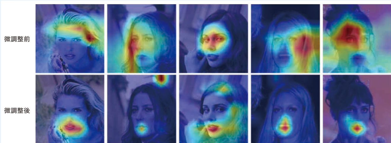
CelebAデータセットの「口紅」に関するデータセットで、ワンクリックアノテーション前に深層学習ネットワークが認識した領域の例(上)と、微修正後の領域の例(下)。目や頬など、唇以外の化粧の参照が軽減されている。
