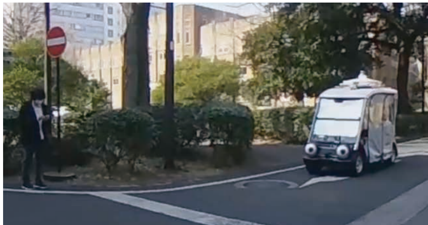
図3 「目」を持つ自動運転車に対する歩行者の反応を実験で調査
