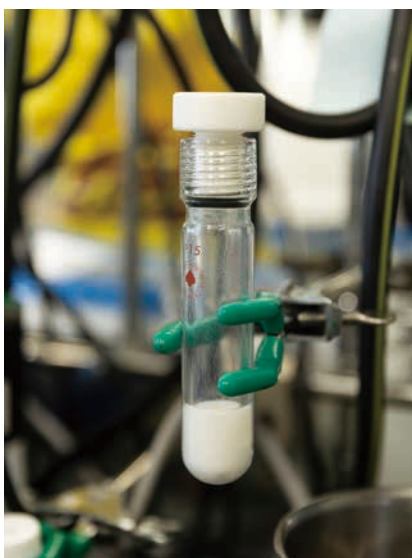
市販のPETボトル片とエタノールにチタン触媒を加えた状態(左)。反応後の様子、原料のテレフタル酸ジエチルの白色沈殿が見られる(右)。ポリマー原料が定量的に回収できる。
