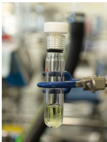
市販のPETボトル片とエタノールにチタン触媒を加えた状態(左)。反応後の様子、原料のテレフタル酸ジエチルの白色沈殿が見られる(右)。ポリマー原料が定量的に回収できる。
