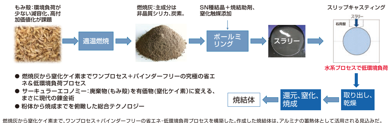
図3 もみ殻を原料とするセラミックス部材の製造プロセス
