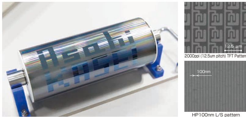
最新の長さ21センチメートルのローラーモールドのデモ機(左)。従来の一筆書きによる電子線描画で作成すると100年かかると試算されていたが、約20時間で全幅・全周を露光できる。ナノメートルレベルの複雑なパターンや、100ナノメートル幅の細いラインも転写できる(右)。
