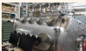
無電極プラズマ推進機試験装置。調整の際には、装置の中に2~3時間こもって作業することも。
