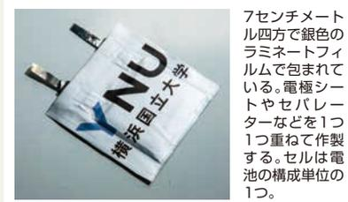
を試作し、350ワットアワー毎キログラムという高い重量エネルギー密度を達成した(図2)。
