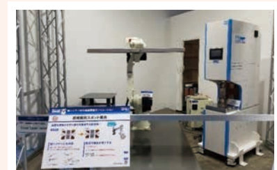
図7 国際ウエルディングショーで展示された固相抵抗スポット接合
