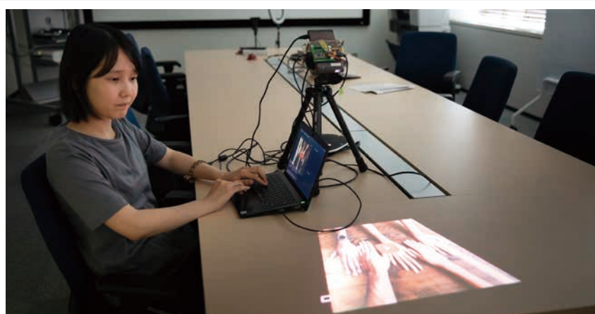
図4 投影画面を指先で操作するタッチセンシング技術
