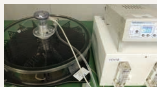
さまざまな匂い物質をあらゆる濃度でマウスに曝露する装置。マウスの不快感を行動試験で評価し、脳内のたんぱく質変化などを解析します。
