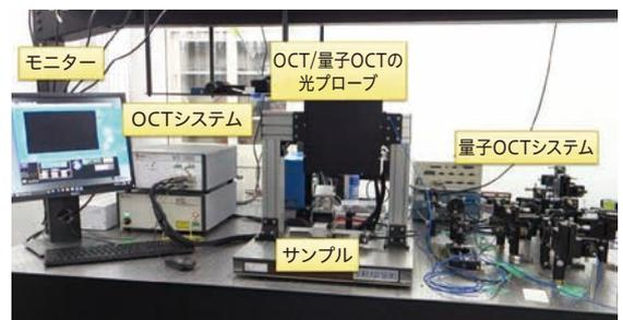
既存のOCTシステムに量子OCTを組み込んだ、高速・高分解能のOCTハイブリッドシステム。通常の分解能でのスキャンを古典OCTで高速広範囲に実施し、特定の箇所をOCTによる超高分解能断層撮影を行う。
