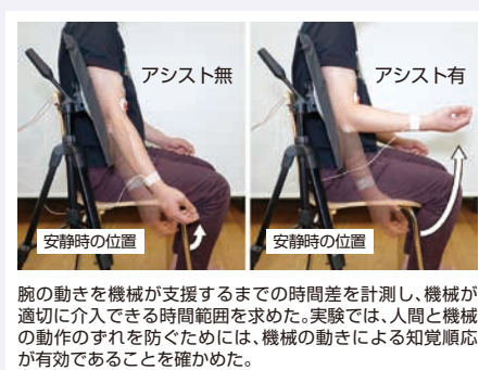
図4 人間の運動を予測・支援する人間機械協調システム
