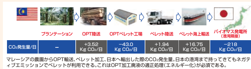
図5 パームバイオマス原料マルチ化処理プロセスからの各ペレットの特徴
