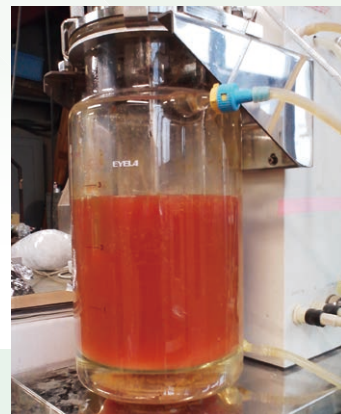
難培養性微生物の培養装置。微生物が育成 するほど赤みを増します。2年以上かかってこ こまで培養が進化したときは大感激でした。
