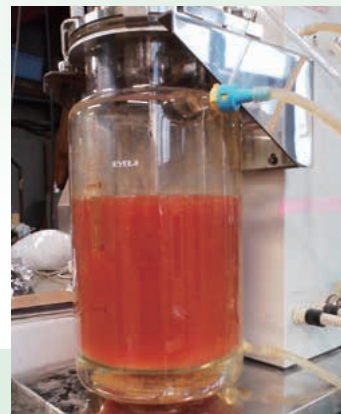
難培養性微生物の培養装置。微生物が成育するほど赤みを増します。2年以上かかってここまで培養が進化したときは大感激でした。
