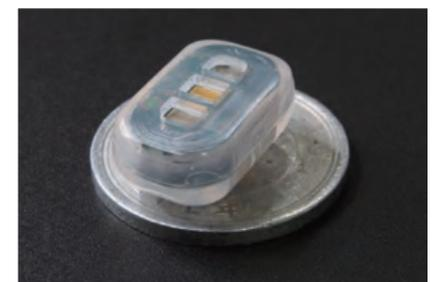
図4 胃酸で発電する「飲む体温計」。1円玉の直径とほぼ同じ大きさの錠剤サイズだ。
