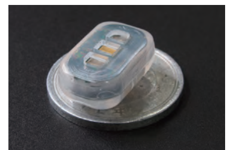
図4 胃酸で発電する「飲む体温計」。1円玉の直径とほぼ同じサイズの錠剤サイズだ。
