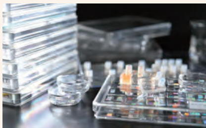
培養基材の作製に使う微細加工フィルムや開発中のマイクロ流体デバイス
