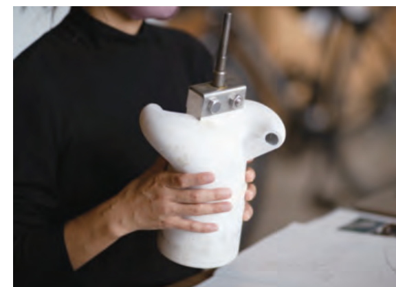
図6 Jet水車(左)とその模式図(右)。一般的な水力発電では、ノズルと水車が別になっており、ノズルから放出した水を水車に当てて水車を回転させる仕組みなのに対し、Jet水車はノズルから噴出される水の反動で水の噴出方向と反対向きにノズル自体を回転させる水車だ。3Dプリンターで試行錯誤を重ね、この形がで上がった。
