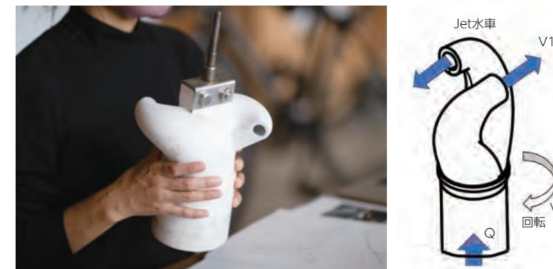
図6 Jet水車(左)とその模式図(右)。一般的な水力発電では、ノズルと水車が別になっており、ノズルから放出した水を水車に当てて水車を回転させる仕組みなのに対し、Jet水車はノズルから噴出される水の反動で水の噴出方向と反対向きにノズル自体を回転させる水車だ。3Dプリンターで試行錯誤を重ね、この形ができた。
