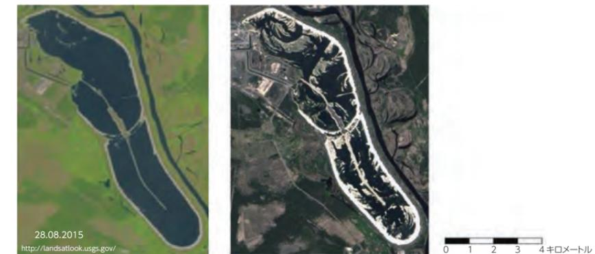
図3 チェルノブイリ原発CPのLandsat衛星写真。水位低下初期(左。15年8月撮影、水面標高107.5メートル)に比べ、水位低下後期(右。17年5月、水面標高106.3メートル)ではかなり水位が低下したことがわかる。図はアメリカ地質調査所(USGS)のLandsat-8データを使用して作成。
