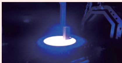
東北大学流体科学研究所の風洞施設を利用した実験のひとつ。白く光っているのがPSP。
