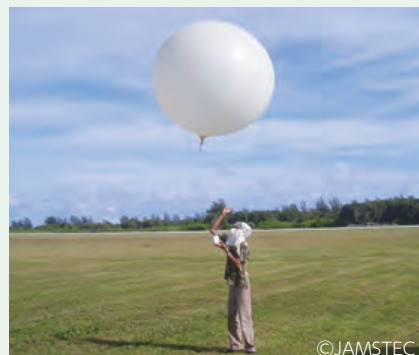
ラジオゾンデ観測(モルディブにて)。対流圏上部18~20キロメートルまで飛ばすことができる。
