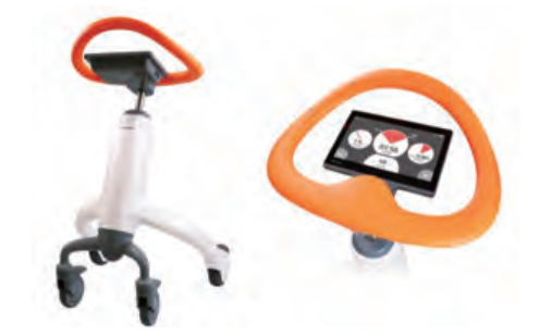
図8 パナソニックが開発した歩行トレーニングロボット「Walk training robo」
