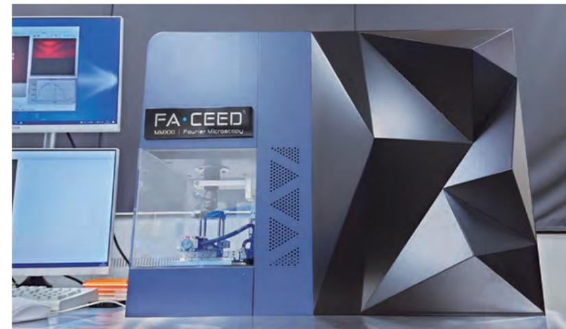
図10 フォトニックバンドダイアグラム顕微鏡「FA-CEED」の外観
