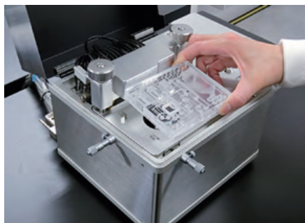
図5 現在開発中の「がん診断デバイス」。血液中のマイクロRNAを検出することで、疾患の発見や病状の把握に役立てることができる。小型で迅速ながん診断が可能なのが特徴だ。今後は血液だけでなく、尿や唾液に含まれるマイクロRNAも検出できるようにすることで、低侵襲診断が可能になる。
