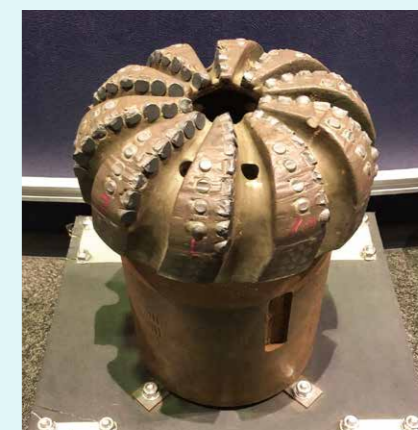
地球深部探査船「ちきゅう」の掘削用コアビットの実物。東北地方太平洋沖地震調査で使用した。人工ダイヤモンドの切断面がぼろぼろになった姿をじかに見ることができる。
