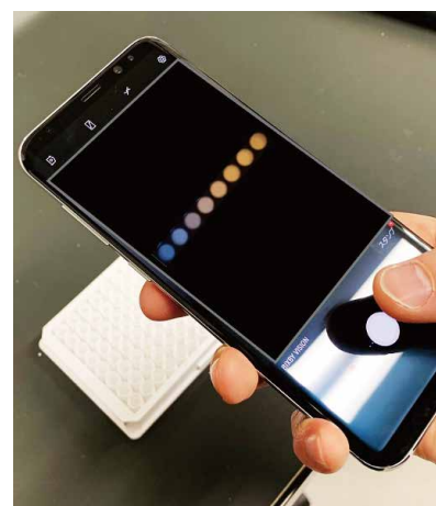
図2 スマートフォンカメラでの撮影による血中ビリルビンの濃度測定。成分を調整したマウス血液3マイクロリットルにBABIを混合し、その発光をスマートフォンカメラで撮影した。得られた画像を赤・緑・青の3成分に分解して、どの成分が変わっていったかを突き止めた。
