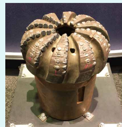
地球深部探査船「ちきゅう」の掘削用コアビットの実物。東北地方太平洋沖地震調査で使用した。人工ダイヤモンドの切削面がぼろぼろになった姿をじかに見ることができる。
