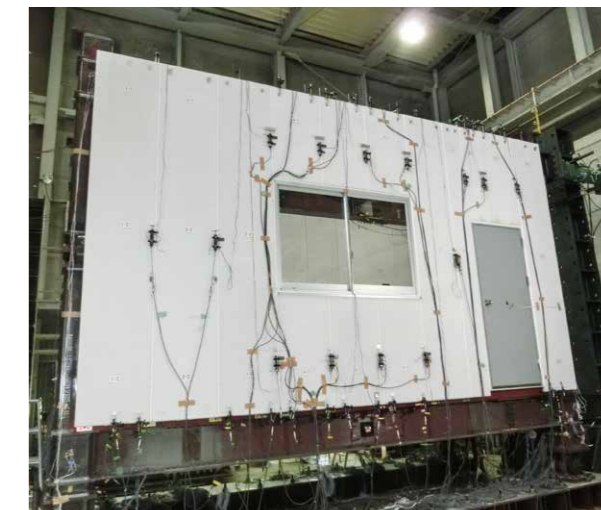
図3 実物大の壁にセンサーを取り付けた実験の様子
