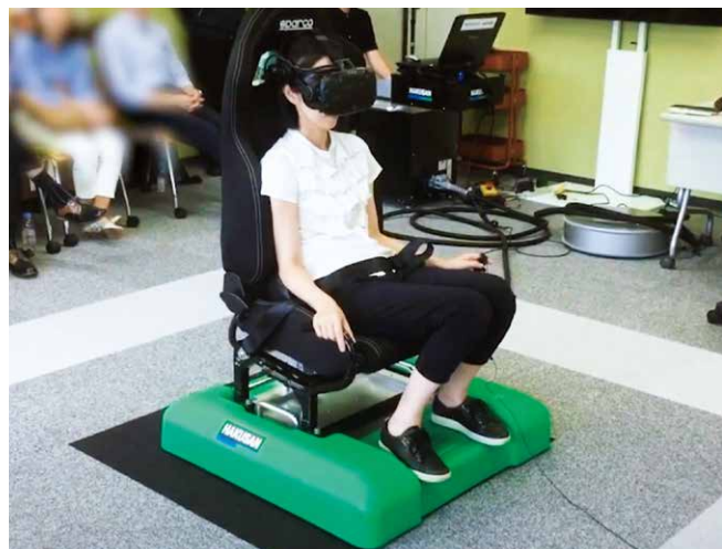
図6 VRグラスで揺れる室内の映像を見ながら「地震ザブトン」に座って揺れを体験すると、被験者は強い恐怖を感じる。こうした実験を通じて、必要以上に恐怖を感じさせないようにする情報提供の方法を模索している。
