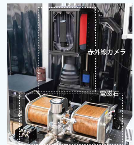
図2 熱物性計測に欠かせないロックインサーモグラフィ。実験室には自作や特注の装置も多く並ぶ。
