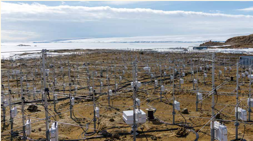
図1 高さ3メートルのアンテナ1045本からなるPANSYレーダー。2015年の本格稼働以来、昭和基地の上空約100キロメートルまでの風向、風速などを常時測定し、極域の大気の流れや大気波動の研究に貢献している。(提供:国立極地研究所)
