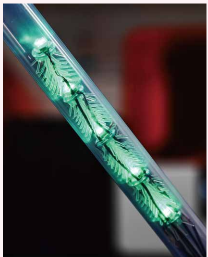
図3 狭い配管を検査しながら自在に動き回る配管探査ロボット。毛を振動させて進み、汚水の中でも確実に動作できる。
