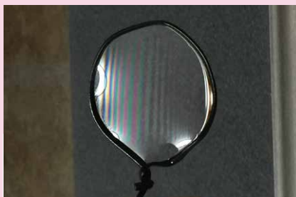
図1 シャボン膜は枠に付着して薄い液膜を保持している。
