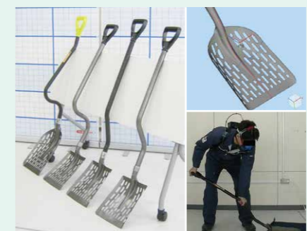
図 Z型復興シャベルの各種試作品(左)。軽量化と強度維持を両立するデザインや素材を検討、試作品で模擬作業者の酸素摂取量と作業量を計測し、人間工学的に検証、評価した(右)。
