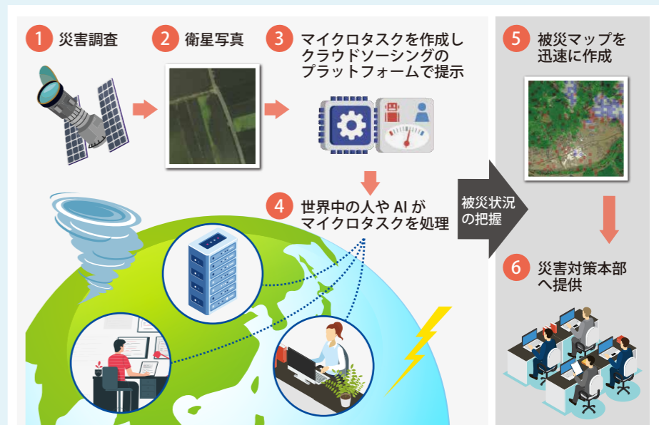
図2 サイバー防災訓練の概要図。衛星写真を格子状に分解し、それぞれについてAIと人が協力して浸水の度合いを判断していく。これを再度統合することで、詳細な浸水情報を迅速に把握し、災害対応に役立てられる。
