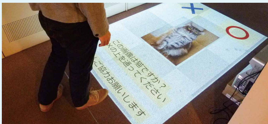
図6 床に提示されている問いを見て判断し、回答の上を通過する。どの位置を通ったかはセンサーで検出する。
