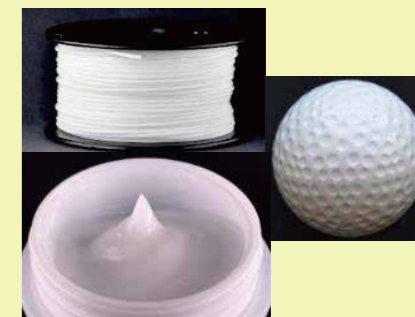
図3 TPIは、3Dプリンター用フィラメント（上）、ゴルフボール（中）、化粧品（下）の成分などに使われている。
