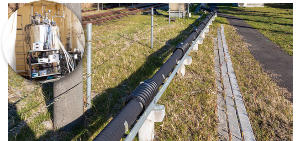
■図3 走行試験を実施した鉄道総研内の実験線。起点には冷凍機と液体窒素の循環用ポンプなどがある(囲み写真内)。
