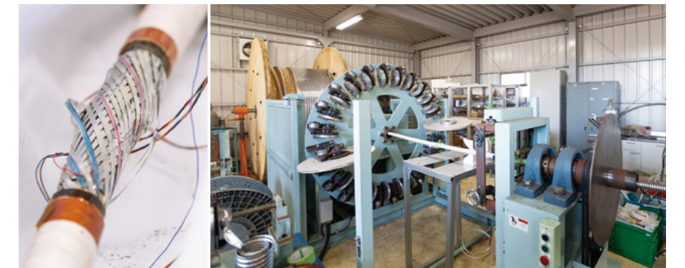
■図2 テープ状の超伝導線材をらせん状に取り付ける装置(右)。後ろに写る巨大なドラムにケーブルを巻いて運搬する。出来上がったケーブルの耐久性の評価実験も行っている。
