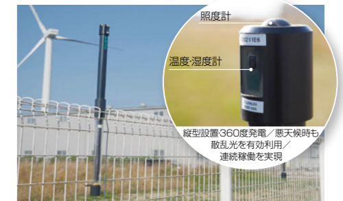
■図2 フジコー敷地内でのセンサーデバイス性能試験。データはインターネット経由で遠隔地からも確認できる。
