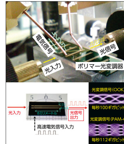
■図2 電気光学ポリマーを使った超高速光変調器とその光変調特性
