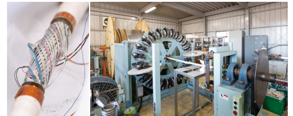
■図2 テープ状の超伝導線材をらせん状に取り付ける装置(右)。後ろに写る巨大なドラムにケーブルを巻いて運搬する。出来上がったケーブルの耐久性の評価実験も行っている。
