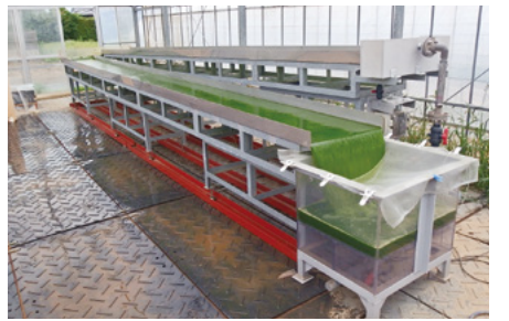
図4 150リットル規模の大量培養設備。夏頃には1000リットル規模を2台、建設予定だ。
